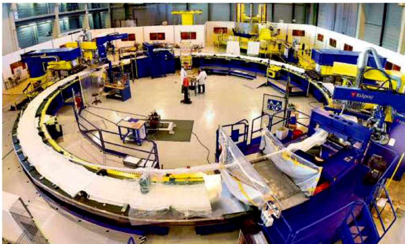
"The Poloidal Field": così viene realizzata parte della bobina poloidale, che servirà alla fine nella fase di assemblaggio
